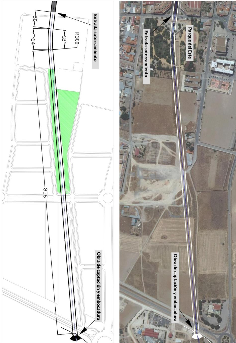
Figura 3. Arriba planta del nuevo trazado propuesto sobre una imagen área. Abajo, el mismo trazado superpuesto con el POM (En verde zona catalogada como Zonas Verdes Locales y Generales). Cotas en metros.
