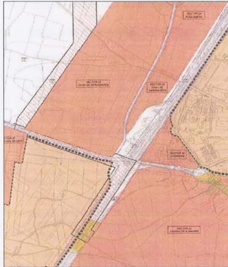
Trazado del corredor eléctrico sobre suelo clasificado como urbano y urbanizable (Detalle del plano OE 1.9 Clasificación del suelo en el TM).
