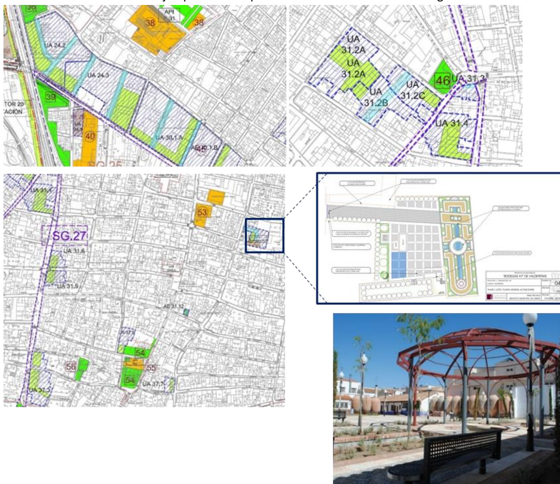
Figura 46. Previsión de Unidades de Actuación para reserva de espacios verdes y apertura de nuevos viales. Ejemplo de Plaza pública en los terrenos de las Bodegas A7
