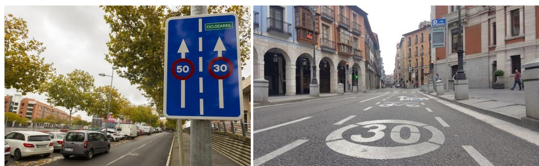
Figura 35. Ciclocarriles: ejemplos de señalización vertical y horizontal. Foto izquierda: Tomás Fernández
