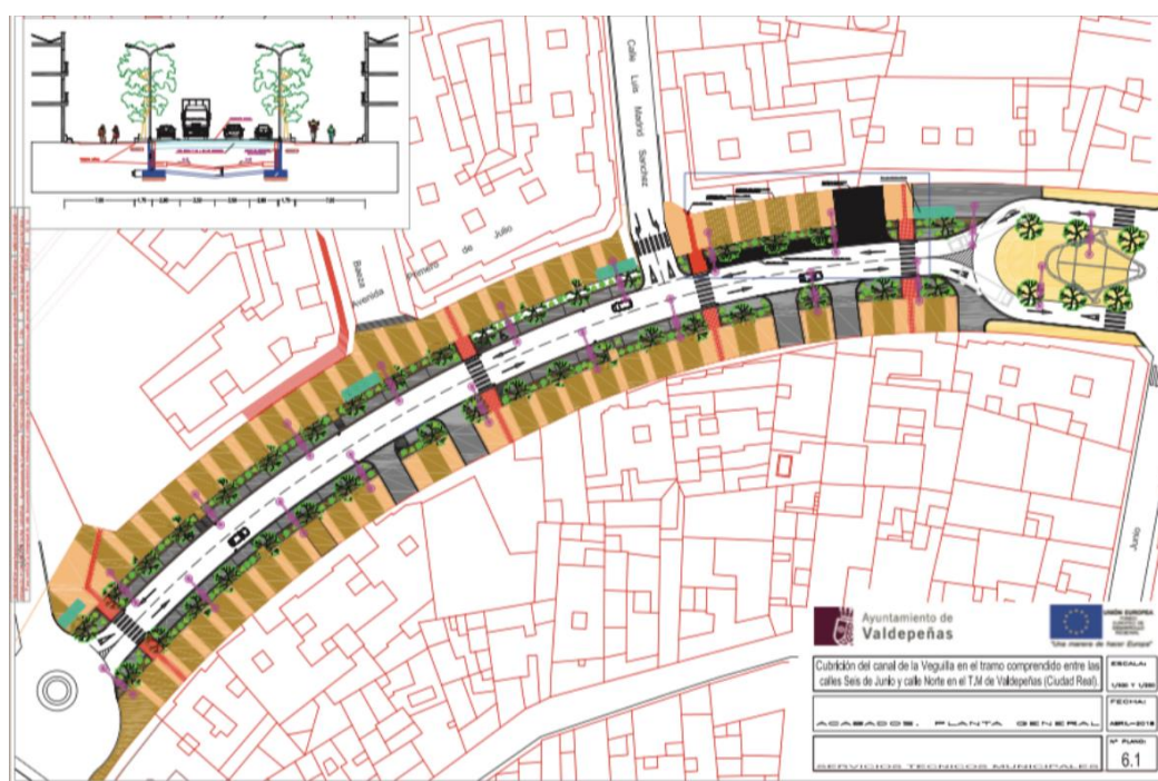
Figura 42. Plano en planta de la cubrición del canal de la Veguilla en el tramo entre las calles Seis de Junio y Calle Norte. Fuente: Ayto. de Valdepeñas.
