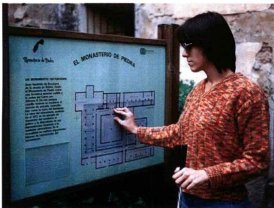
Se señalan una serie de medidas en orden a optimizar la señalización táctil según las necesidades de los invidentes, para quienes está específicamente concebidas, de modo que detecten con su bastón o con sus pies franjas de pavimento especial señalizador y con sus dedos la información escrita o gráfica en general que se les ofrezca en un plano:
